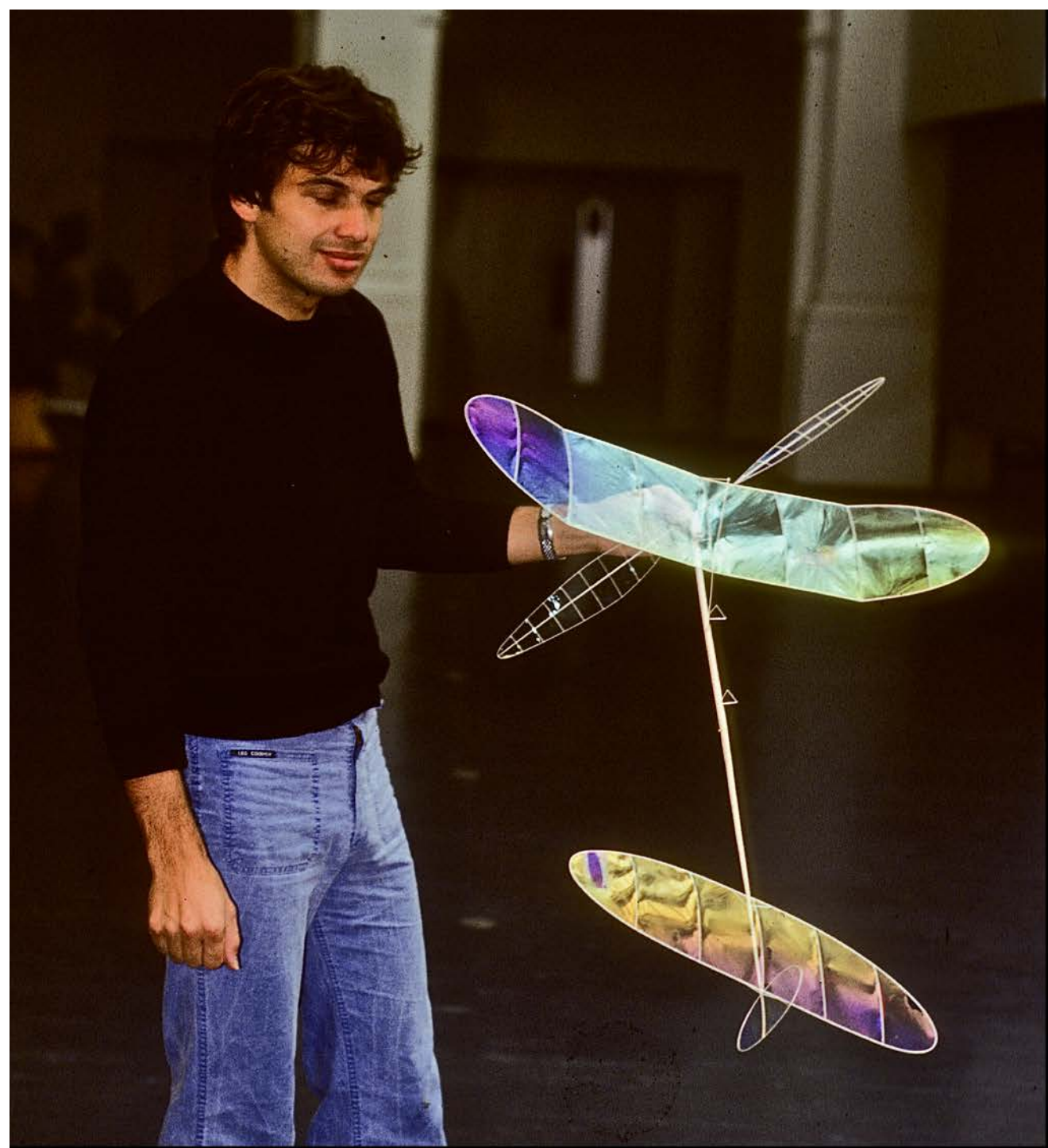
Beim Saalflug kommt es darauf an, das 2 Gramm schwere Modell mit Gummimotor möglichst lange in der Luft zu halten. Der Weltrekord lag damals bei 52 Minuten. Der ETH-Student Dieter Siebenmann berechnete die Struktur des Flugzeugs bereits 1977 mit einem Computerprogramm und baute es danach selbst.
